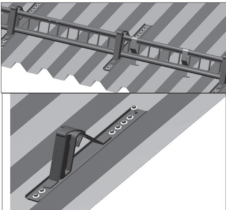
**NB! Siden snøfangeren bare festes til platene, er det viktig at takplater og underkonstruksjon er tilstrekkelig innfestet til å kunne opppta den økte belastningen fra snøfangersystemet!**
