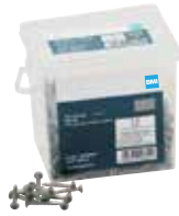
BMI skruer Nobb: 48783923 5,0 x 35 mm. Forbruk: 10 stk. pr. m 2 . Stålkvalitet AISI 410. 500 stk. pr. boks.
