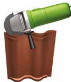
Bilde 12. Det er viktig å slipe bort litt av undersiden på taksteinen, slik at taksteinen ikke blir liggende å "ri" på taktilbehør.
